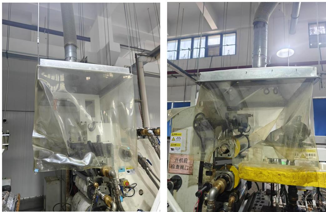
图 4-2 挤出机集气罩
