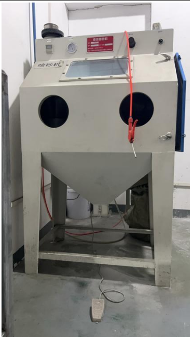
喷砂机自带袋式除尘器
