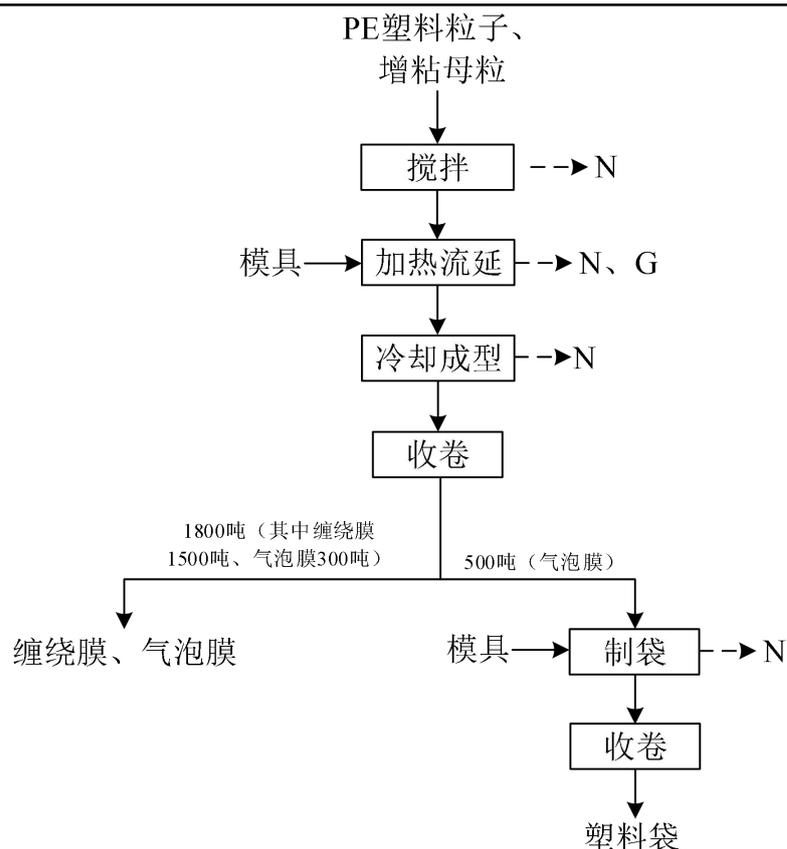
图 2-2 缠绕膜、气泡膜和塑料袋生产工艺流程及产污环节图
