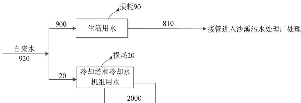
图 2-1 本项目水平衡图 (t/a)
