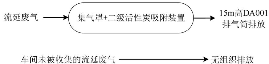
图 4-1 废气处理工艺流程图
