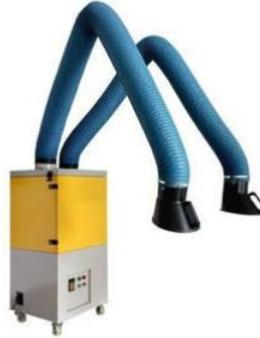
图 4-2 移动式烟尘净化器
