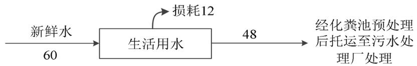
图2-4 现有项目水平衡图（单位t/a）
