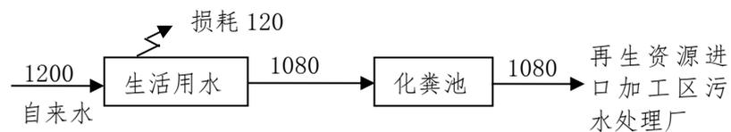
图 5 建设项目生活污水用排水平衡图 (单位 t/a)
