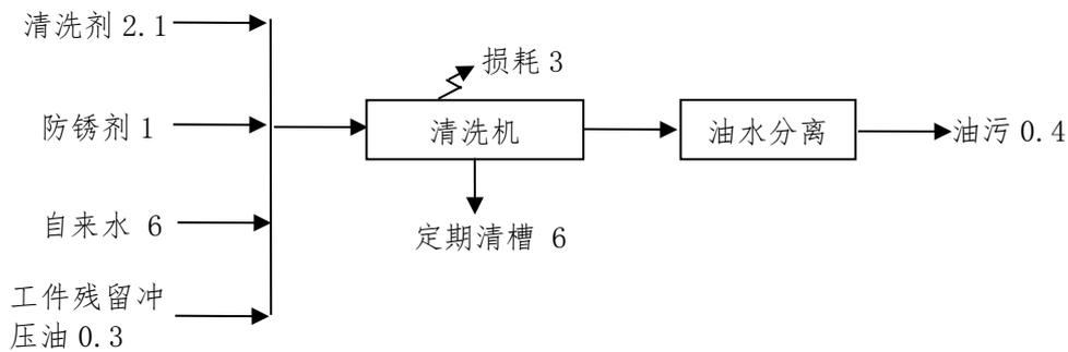
图 4 建设项目清洗水平衡图 (单位 t/a)
