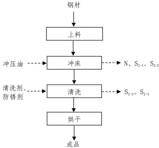
图 2 导向架生产工艺流程图
