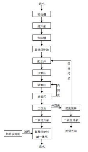
图4-3 浏河污水处理厂污水处理工艺流程图
