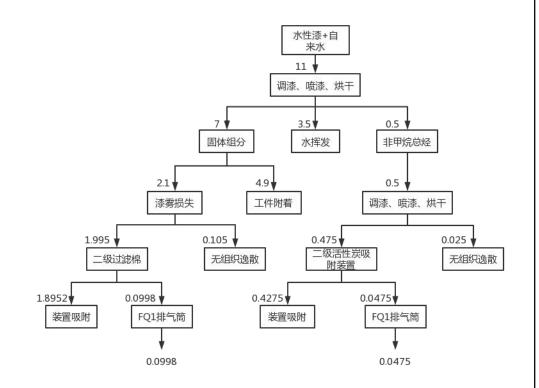
表 2-1 水性漆喷漆工艺物料平衡图
