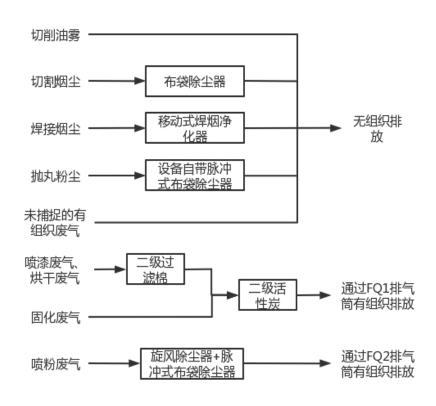
图 4-1 废气处理流程图
