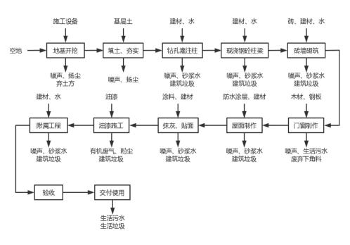
图 2-3 本项目施工期工艺流程图
