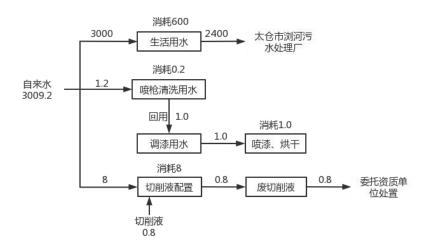
图 2-2 本项目水平衡图 (t/a)
