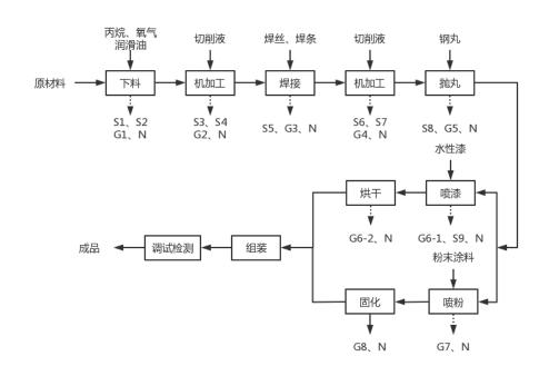
图 2-4 生产工艺流程及产污环节图
