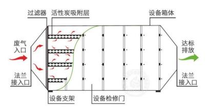
图 4-2 吸附箱结构示意图及工作原理
