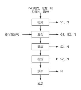
图 2-3 汽车内饰件复合材料生产工艺流程
