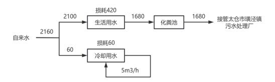
图 2-1 本项目水平衡图 (m³/a)
