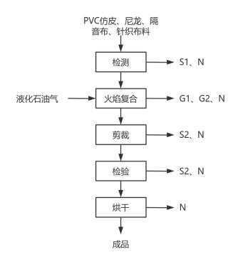
图2-2 汽车内饰复合材料生产工艺流程及产污环节图
