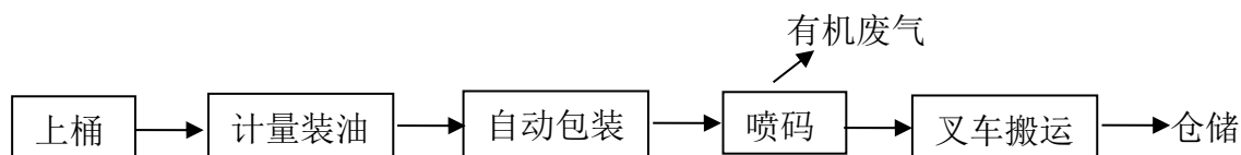
图 2.4-4 1000L 桶灌装工艺流程及产污环节图
